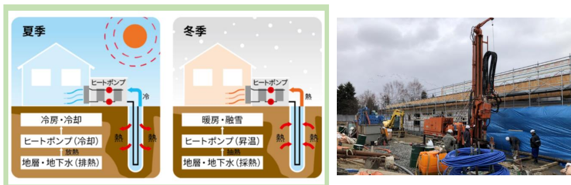
図 5-3 地中熱利用システムの仕組み（左）／認定こども園における設置工事（右）
