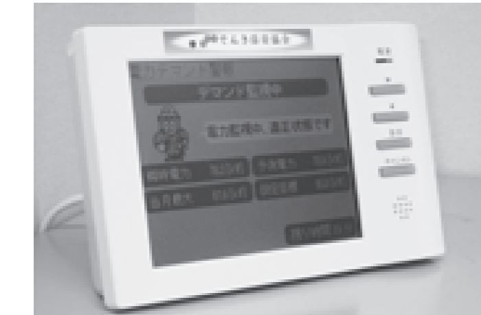
役場庁舎へ試験設置中のデマンド値監視モニター
