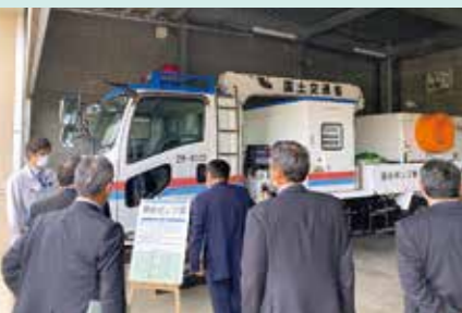
常備されている排水ポンプ車【北広島河川防災ステーション】
