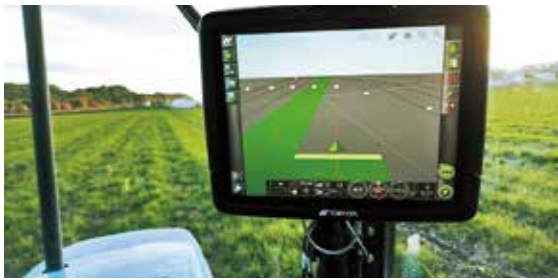
トラクターに取り付けられたGPSガイダンスモニター
