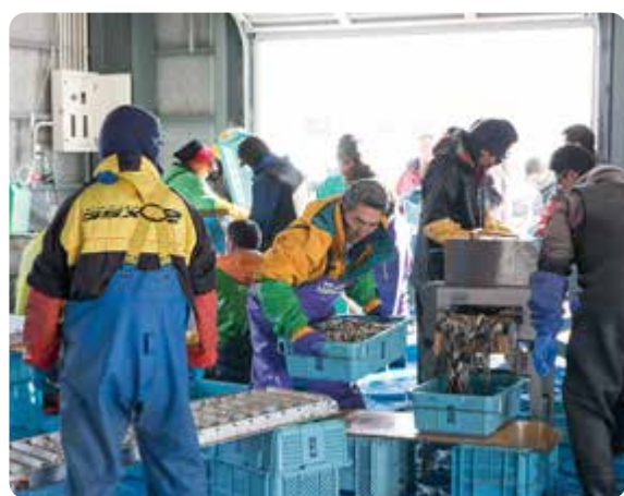
① 金属検出機を通して、釣り針などの金属がないか確認し、次々に20kg用の箱に入れられます。
