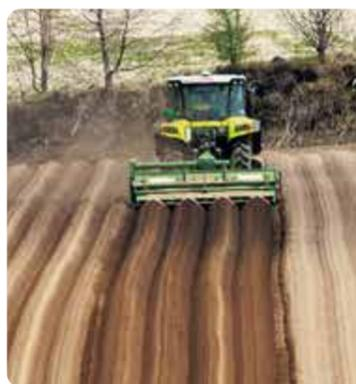
トラクターに取り付けたGPSセンサーと、運転席内にあるディスプレイにより、トラクターの走行位置を把握して、すでに耕した場所とこれから耕す場所が重ならないように走行することができます。
