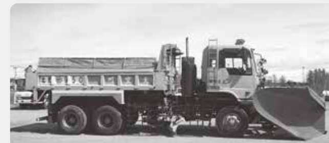
【1】除雪ダンプ(10t級、Vプラウ、路面整正装置付)
