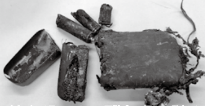
令和4年12月14日、21日に不燃ごみに混入し、発火した電子タバコ機器・モバイルバッテリー
