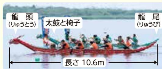
大空町で使用するドラゴンボートは10人乗りで、長さ10.6m、幅は1.06mです。船尾には舟を操船する舵棒が付いています。こんなに大きなドラゴンボートがレースをする姿はまさに圧巻です!
